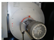
Moto -ventilateur / Fan and motor RSB 65-75
