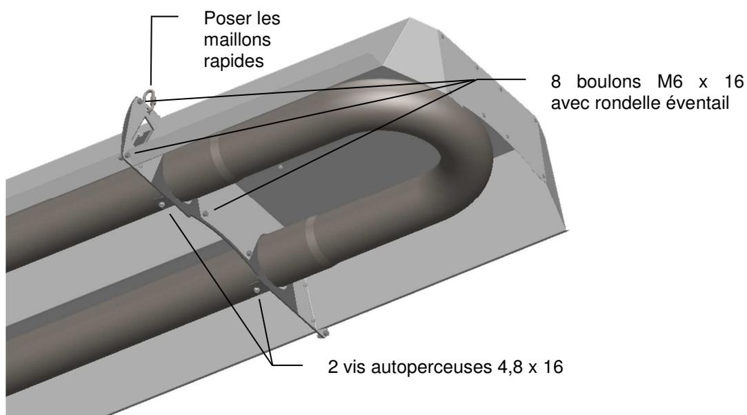
Côté extracteur, appliquer 2 anneaux continus de colle mastic haute température à environ 20 et 40 mm de l'extrémité du tube.
