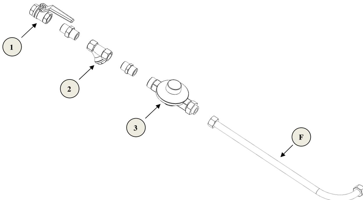
(1) Vanne quart de tour gaz - (2) Filtre gaz - (3) Détendeur gaz (pour pression > 50 mbar)
